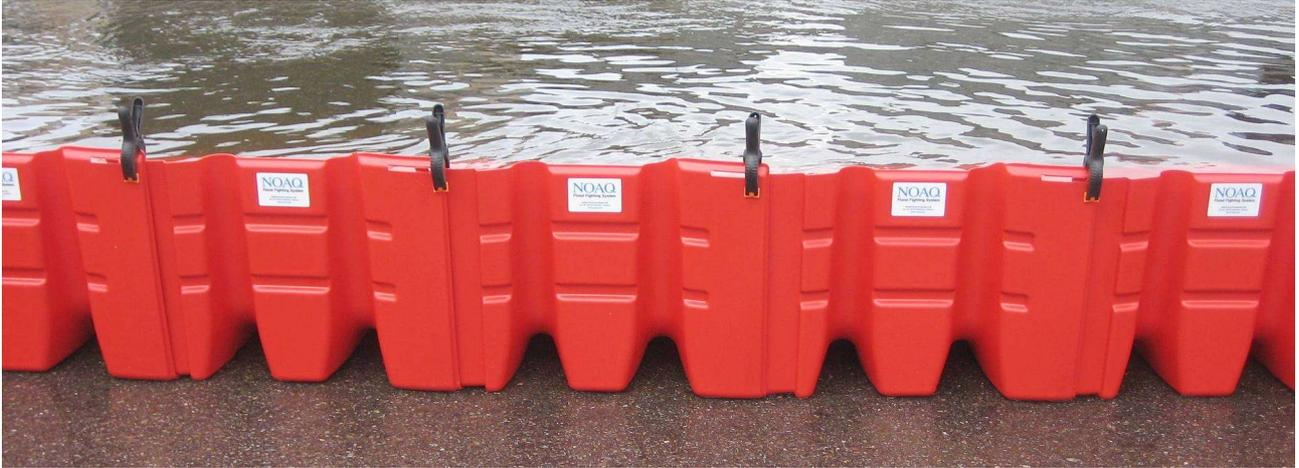
Der NOAQ Boxwall ist ein selbstverankernder mobiler Schutzwall gegen Überschwemmungen. NOAQ Boxwall BW50 dämmt Wasser bis zu einer Höhe von 50 cm. Dank des geringen Gewichts lässt sich der Boxwall schnell errichten, um Gebäude und sonstiges Eigentum vor Wasserschäden zu schützen bzw. Straßen offen zu halten. Der Boxwall ist für den Einsatz auf fester und ebener Unterlage wie Straßenbelägen und Betonfußböden vorgesehen. Der Boxwall ist in zahlreichen Ländern patentrechtlich geschützt.
